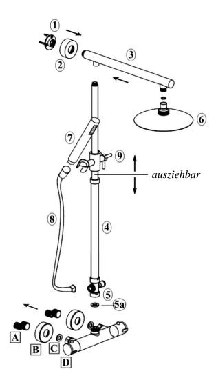
1. Montieren Sie den Thermostatmischer in der gewünschten Position wie folgt.
