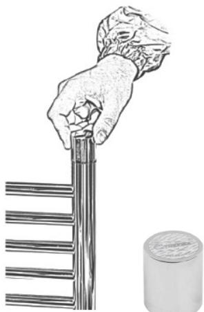
DK - Monter top hætten på adapterens gevind. Gentag tidlige punkter på radiatoren anden side.
