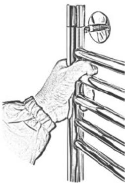
DK - Installere radiatoren på væggen ved at skubbe de 4 ophængs bolte ind i de 4 bøs på væggen. Tilslut herefter radiatoren til varmesystemet eller monter et varmelegeme.
