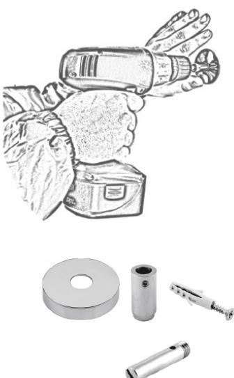
DK - Placer radiatoren på væggen i den ønskede højde og afmærk de 4 anborings punkter. Bor de 4 huller og indsæt de 4 rawplugs. Hold rosetten op til hullet og montere ophængs bøsset så det holder rosetten på plads. Se tegning på side 10.
